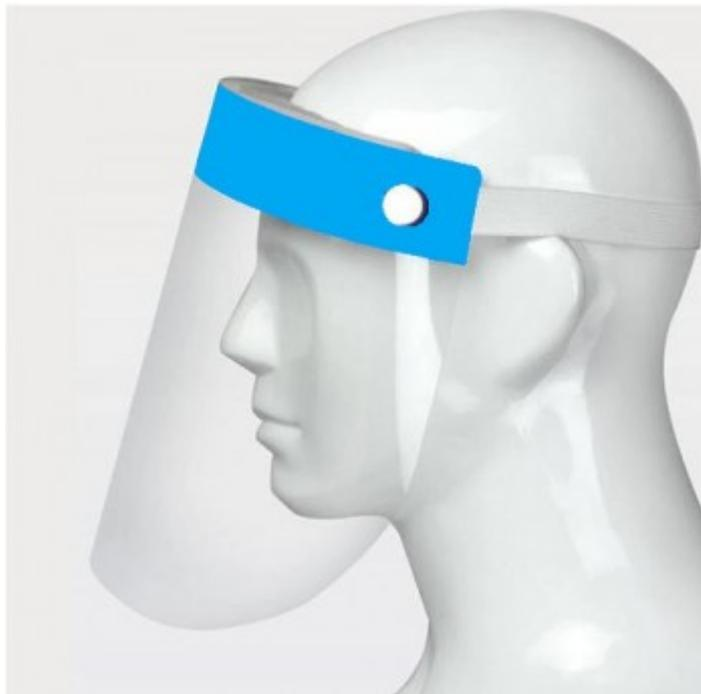
Bardatura morbida anallergica in appoggio alla fronte, banda elastica regolabile, sovrapponibile ai comuni occhiali da vista e facciali filtranti o mascherine chirurgiche; schermo in acetato antiappannamento. Marcatura CE, conformità a EN166 e D.Lgs 475/92.
